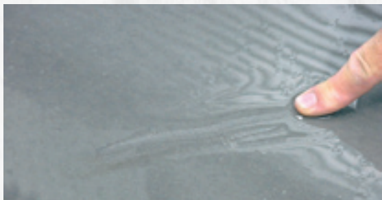
Trennmittel mit zu grosser Auftragsmenge
