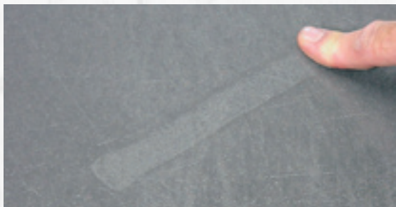
Trennmittel mit richtiger Auftragsmenge
